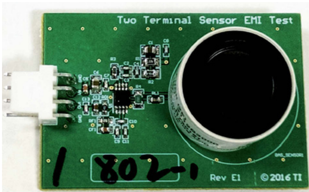
Figure 2 : carte soumise aux essais avec capteur
