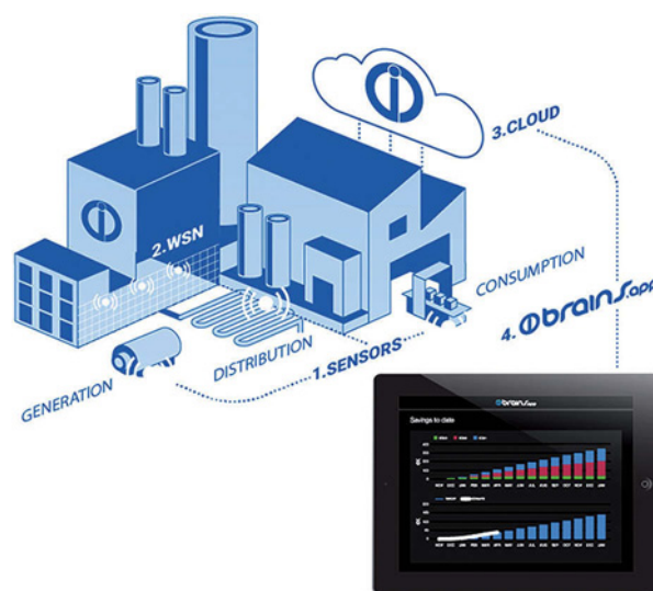
Figure 3 Conduite du changement - Les logiciels d'analyse, comme par exemple Brains.App, proposé par IntelliSense.io, utilisent les données générées par les réseaux industriels de capteurs sans fil pour rationaliser les activités des installations industrielles, optimiser le rendement et améliorer la sécurité.
