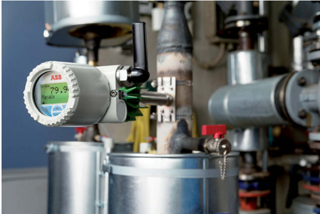
Figure 1 - Des capteurs implantés partout – Il est possible d'implanter de manière optimale des noeuds équipés de capteurs sans fil basse consommation alimentés sans limite de temps par de l'énergie récupérée, comme par exemple ce capteur de température sans fil avec récupération d'énergie thermique proposé par ABB, pour acquérir des données supplémentaires dans une installation industrielle.
