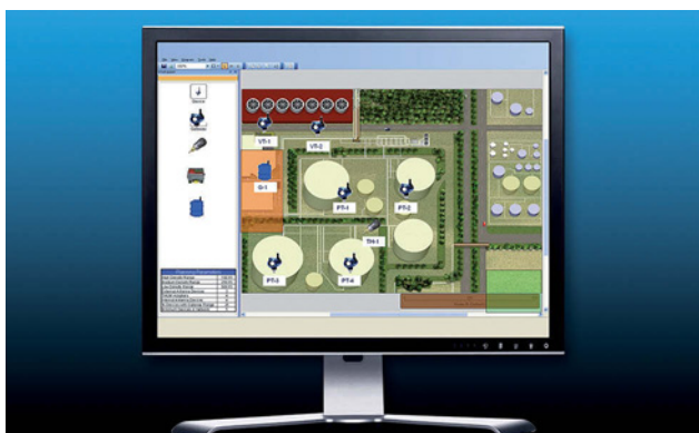
Figure 2 - Visibilité du réseau - Le logiciel de gestion réseau apporte une visibilité cruciale sur l'état du réseau sans fil, par exemple avec cet utilitaire SNAP-ON proposé par Emerson Process Management.
