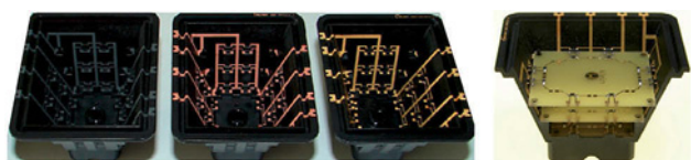
Illustration 1 : Le capteur fabriqué à base de la technologie LPKF-LDS® (à gauche) et les différentes couches réparties en hauteur d'un capteur de pression autosuffisant en énergie (à droite).
