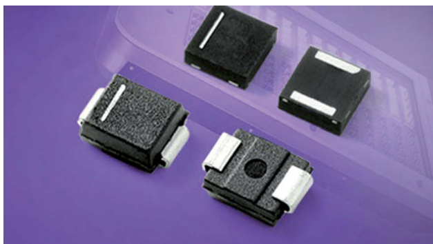
Figure 3 – Comme tout autre type de PLED, les protecteurs PLEDxxUx Unidirectional Series établissent un circuit de shunt électronique autour de la LED qui passe en circuit ouvert. Ce circuit présente la caractéristique V-I typique de premier quadrant, mais dans le troisième quadrant de la diode, et il assure également une protection par inversion de l'alimentation (batterie ou secteur).
