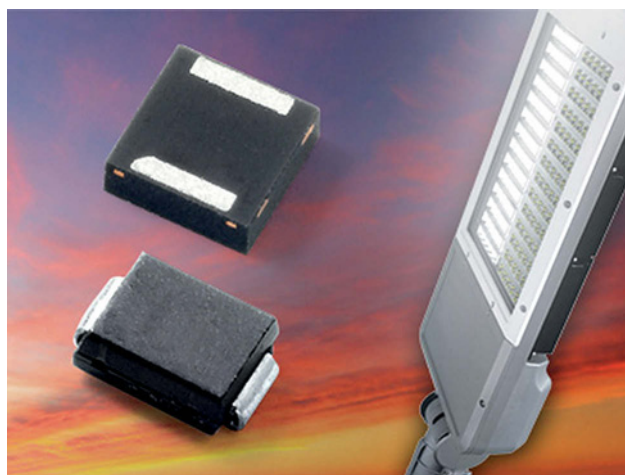
Figure 4 – Les protecteurs PLED Series ayant une tension de claquage minimum de 6 V, sont conçus pour bypasser une seule LED en circuit ouvert de la bande. Ces dispositifs de protection des LED en circuit ouvert supportent jusqu'à 1000 mA de courant continu, ce qui les rend idéales pour protéger les LED de 1 W, 2 W et 3 W.
